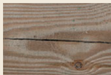
Spannungsrisse durch die Holz Trocknung
