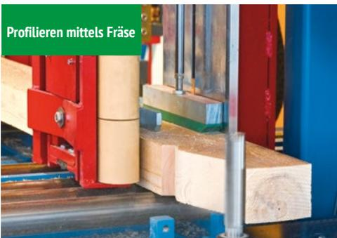
Profilieren mittels Fräse
