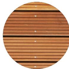
Das überwiegend homogene Holz ist gelblichbraun bis olivbraun, schwer mit hohen Festigkeitswerten. Das Holz ist gut zu sägen und zu bohren.
