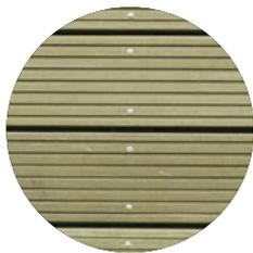
Die grünliche Färbung von kesseldruckimprägnierter Kiefer zeichnet dieses Holz aus. Wie jedes Nadelholz ist Kiefer leicht zu bearbeiten.
